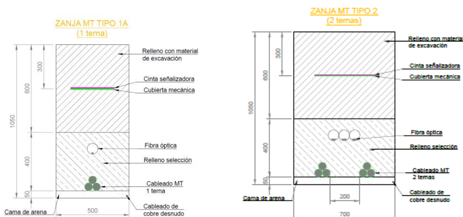
Figura 27 Detalle de zanja MT
