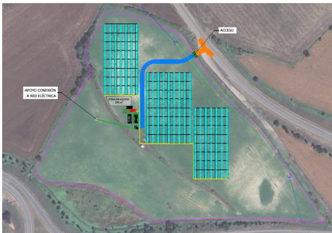
Figura 5 Zanja de media tensión del centro de seccionamiento al apoyo
